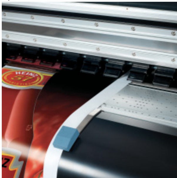
Sistema a vácuo ajustável
