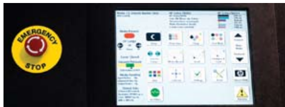
Detalhe do painel de controle sensível ao toque da HP Scitex FB950
